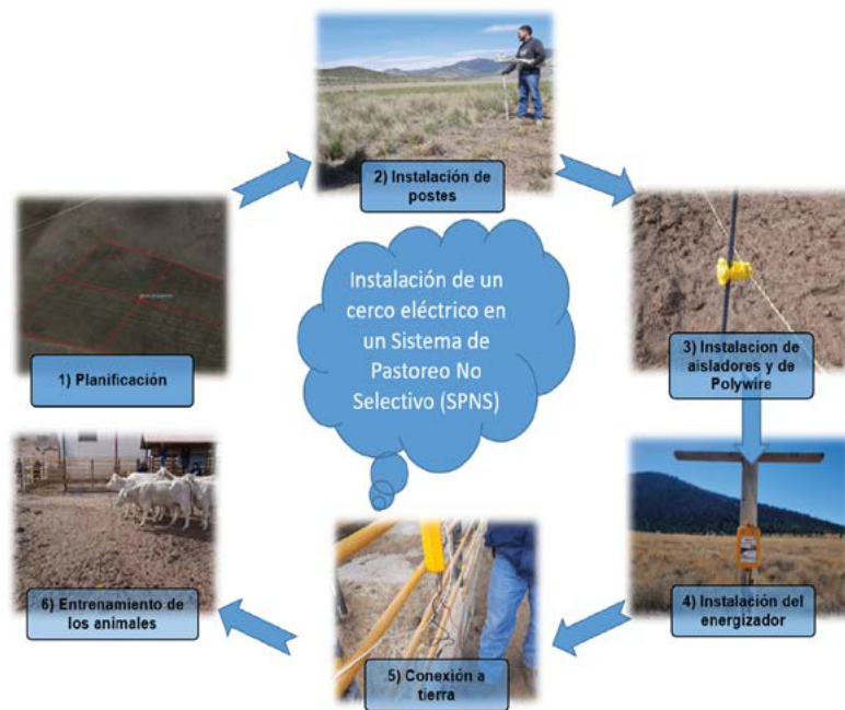
Figura 1. Diagrama del establecimiento de un cerco eléctrico para un sistema de pastoreo intensivo no selectivo (PINS).
