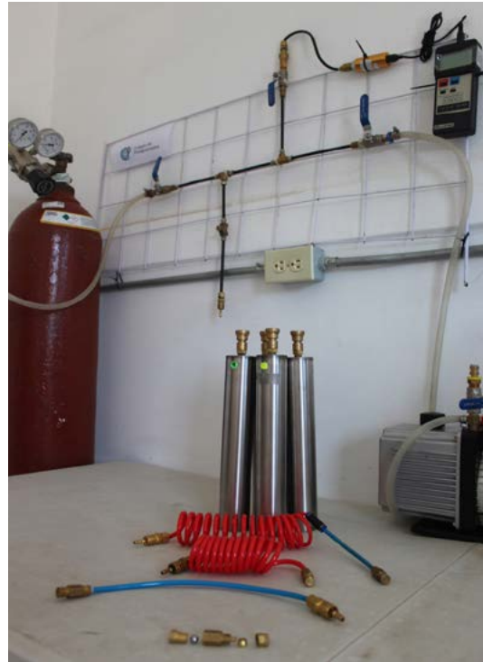
Figura 2. Sistema utilizado para realizar vacío en cilindros (fondo), que consta de cilindros de acero inoxidable y válvulas con mangueras de conexión (frente).
