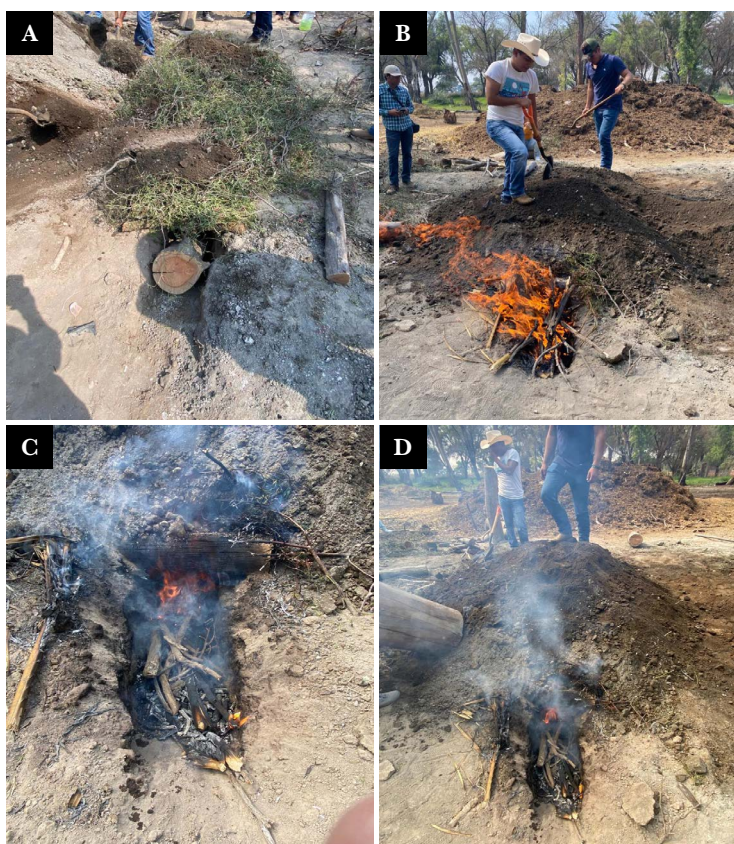
Figura 4. Preparación del encendido de la carbonera. A) se coloca un tronco de madera para que no ingreso el aire, retirándolo una vez que se enciende para generar una succión (respiradero); B) se enciende y se verifica que exista suficientes brasas; C) avance del encendido se comienza a carbonizar y se comprueba el hundimiento; D) se verifica posibles aperturas e ingreso de oxígeno.
