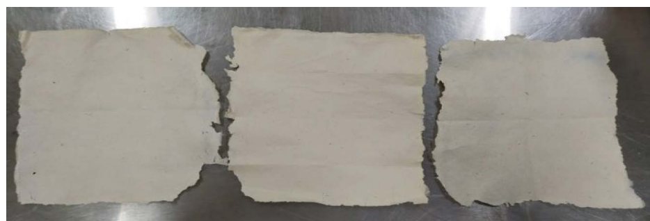
Figura 3. Papel artesanal elaborado a partir de pulpa celulósica de residuos de podas de Jatropha curcas L.
