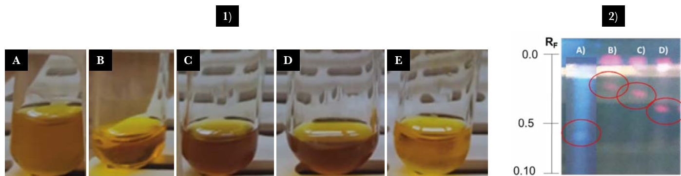
Figura 1. Prueba de alcaloides en 1: A) testigo positivo de Lupinus sp., B) testigo negativo, C) segregante 387 M20, D) segregante 387 M16 y E) Sechium H387 07; 2 A) Prueba de alcaloides separados por cromatografía en capa fina, con diclorometano-metanol 9:1 y revelador Dragendorff: A) estándar de Lupinus sp rf 0.60, B) 387 M20 con rf de 0.31, C) 387 M16 rf de 0.32 y D) Sechium H387 07 rf de 0.40.
