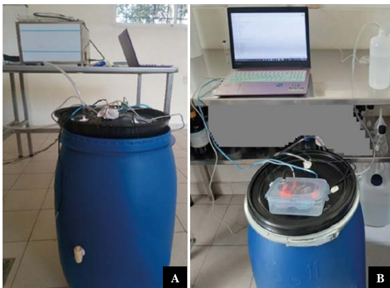
Figura 1. A) Sistema de monitoreo conectado a computadora para verificación de registro de datos en la nube IoT. B) Biofermentador en funcionamiento.
